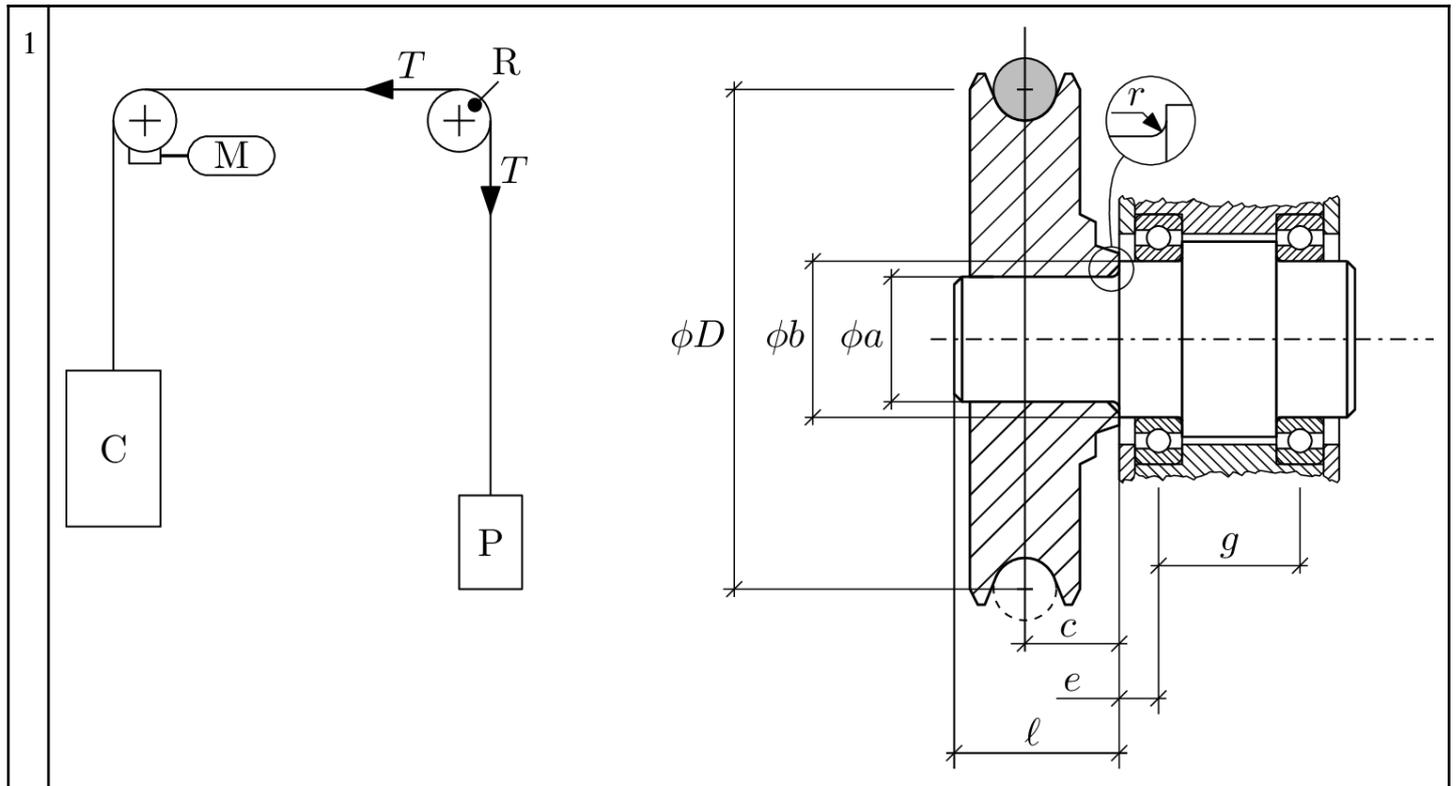
Si consideri il montacarichi di figura in cui la fune che sostiene il contrappeso di peso  $P=6000$  N passa dalla puleggia di rinvio R, per la quale è rappresentato a destra l'albero di supporto, realizzato in acciaio C40.
