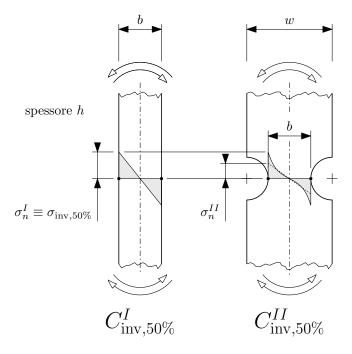
Si comparano i risultati sperimentali a fatica per cicli all'inversione di un provino a geometria regolare, e un provino intagliato. Si considera in particolare una geometria a lastra intagliata, soggetta a momento flettente alterno.
