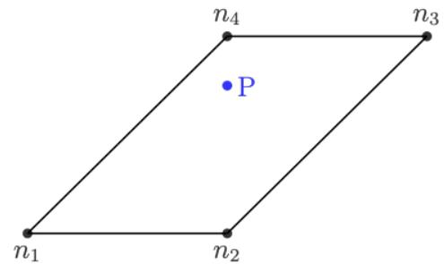
Per meglio visualizzare come si muovono i punti materiali all'interno della piastra riportata in Figura è possibile creare un "reticolo di stecchini" rigidi (rossi): in questo modo si crea un vincolo cinematico che lega il moto di un generico nodo al moto della corrispondente particella materiale della piastra, in modo che tale nodo si sposti secondo le funzioni di interpolazione dei modi dei 4 nodi.
