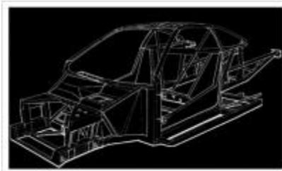
**FIGURA 12 TELAIO TUBOLARE "SPACE FRAME" IN ACCIAIO AD ALTA RESISTENZA PER LA FERRARI F40 DEL 1990; SONO VISIBILI I RINFORZI IN LAMIERA E A SANDWICH NIDO D'APE-FIBRA DI CARBONIO**
